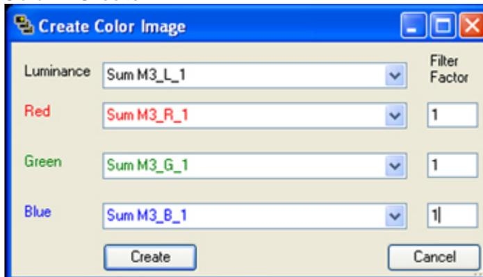
CCD-Stack berücksichtigt die Belichtungszeit, welche im FITS-Header steht. Wer also z.B. beim Rot-Filter doppelt so lange belichtet, muss beim Filter Factor nicht 1:1:1 eingeben, sondern 2:1:1.
